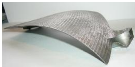
Рабочая модель лопатки гидротурбины. Характерный размер объекта 100 × 190 × 40 мм
